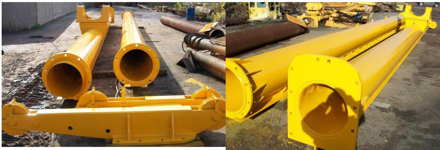
Мачта копровая ГМК-190 предназначена для погружения железобетонных и металлических свай, шпунтов Ларсена сваебойными гидравлическими и дизельными молотами.
